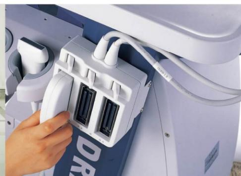
Expansão, por meio de conectores de transdutores instalados no carrinho
